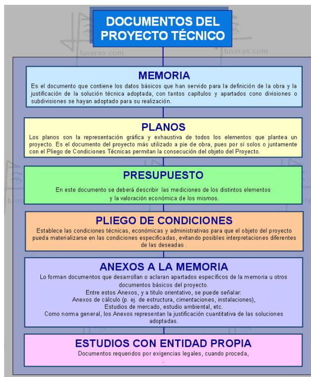
Figura 7.2: Estructura de documentos de un proyecto técnico
